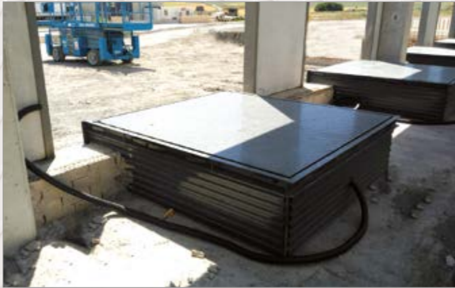
Bancada Box Model con trampilla para albergar la plataforma de los camiones.
