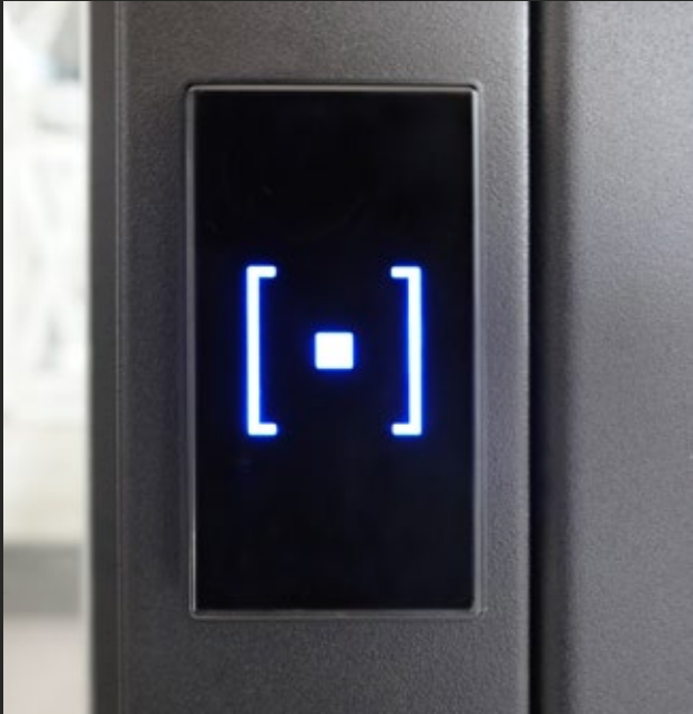
Bouton palier LED rétroéclairé avec activation tactile.
